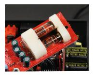
Die beiden Raythean 5703 Subminiaturröhren sind in einer festen, isolierenden Halterung montiert.
