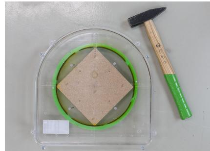
**2.** Placez y la partie inférieure du de la Speaker Box et fixez la à l'aide de 4 clous. (Une fois les clous en place, ils ne doivent pas dépasser du back box).
