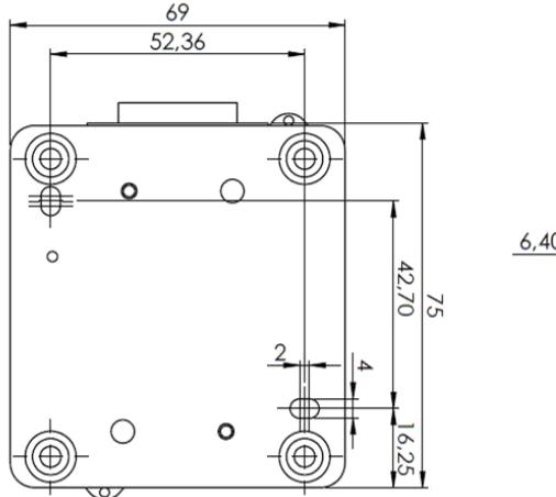
Montage: Kabelverschraubung nach unten
